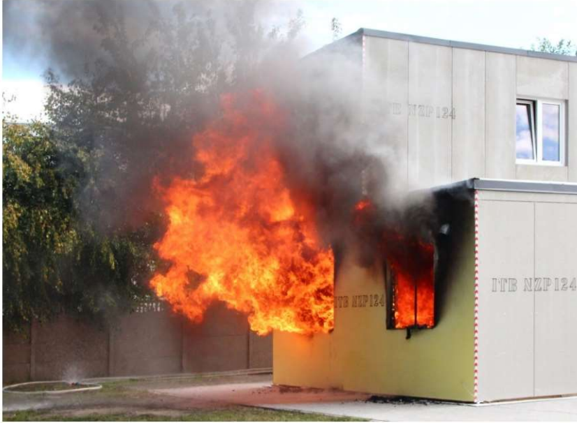
Fot. 7.3 Zasięg płomieni z pomieszczenia, w którym znajduje się źródło ognia. (fot. E.I. Kotwica)
