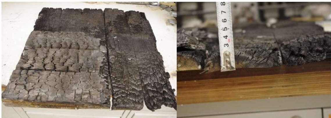
Fot. 6.15. Widok zwęgliny drewna sosnowego po ustaniu bezpośredniego działania ognia (fot. P. Sulik)
